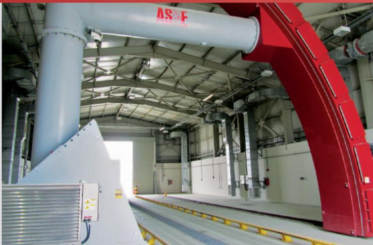
Система OmniView® Gantry от AS&E отличается мощной технологией передачи рентгеновских лучей 6 МэВ, проникающих на глубину до 400 мм (15,7 дюйма) по стали. Система осуществляет сканирование, перемещаясь по рельсам мимо неподвижно стоящего транспортного средства или груза.
