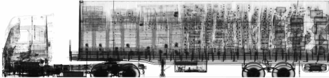
Рис. 7. Образец изображения, полученного системой Eagle G45, в оттенках серого цвета
