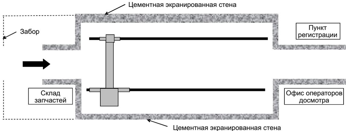
Рис. 3. Eagle G45 с экранированными стенами (поставляются дополнительно)
