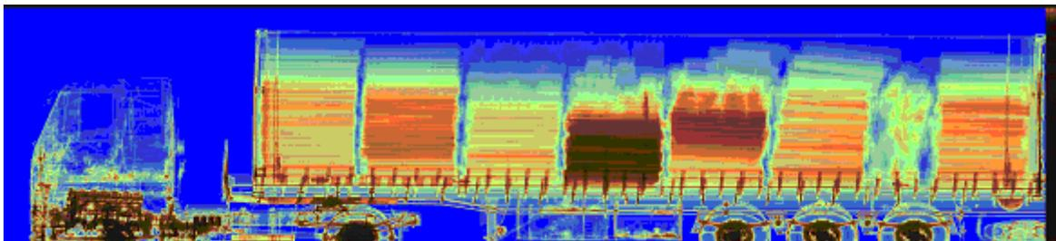
Рис. 6. Образец изображения, полученного системой Eagle G45, в псевдоцвете
