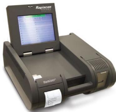
ITEMISER® DX — ПОРТАТИВНАЯ НАСТОЛЬНАЯ СИСТЕМА, ИСПОЛЬЗУЮЩАЯ ДВУХРЕЖИМНУЮ ТЕХНОЛОГИЮ ОБНАРУЖЕНИЯ ОДНОВРЕМЕННО ПОЛОЖИТЕЛЬНО И ОТРИЦАТЕЛЬНО ЗАРЯЖЕННЫХ ИОНОВ, ПОЗВОЛЯЕТ ЭФФЕКТИВНО ДЕТЕКТИРОВАТЬ КАК ВЗРЫВЧАТЫЕ, ТАК И НАРКОТИЧЕСКИЕ ВЕЩЕСТВА.
